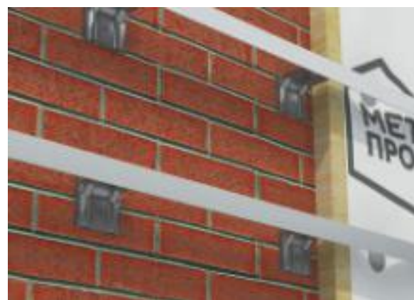
Система с горизонтальным расположением основных профилей
