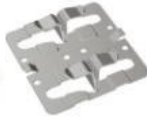
Крепежный кляммер рядовой с дистанциром ККРД-70x10, t=1,2 мм
